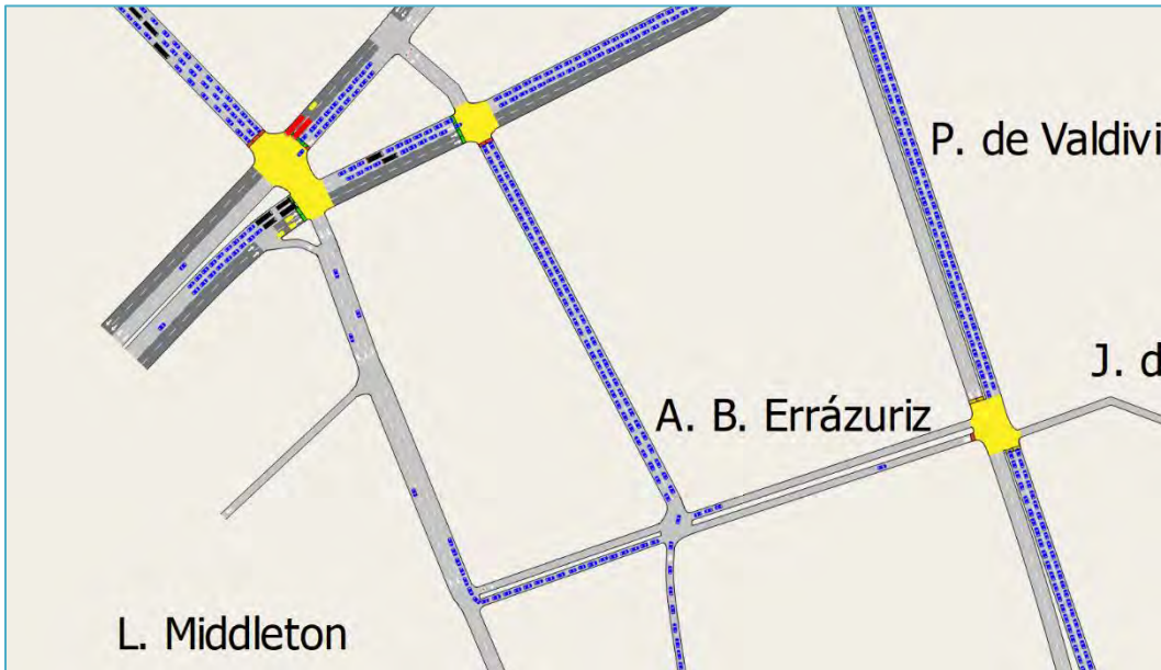
FIGURA N° 5.2-60: MICROSIMULACIÓN SITUACIÓN BASE CALLE PEATONAL MARCHANT PEREIRA
